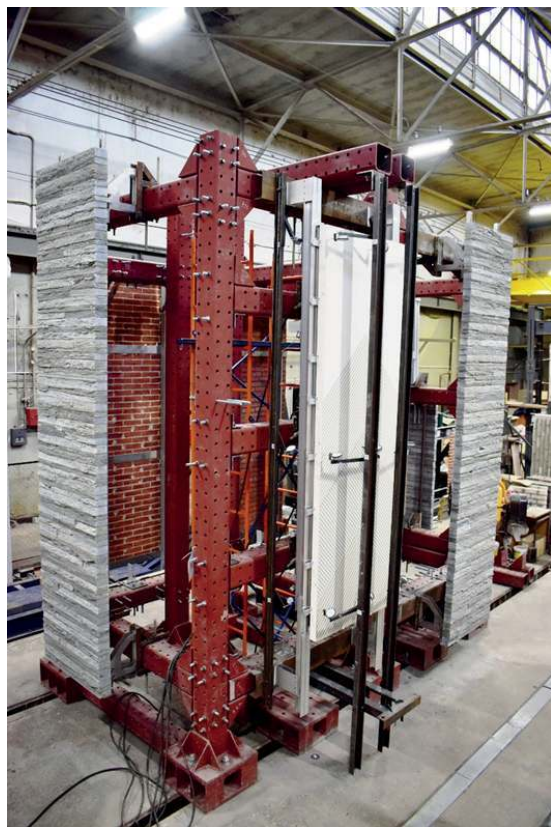
Рис. 1. Испытательный стенд ИС-4 и экспериментальные образцы в процессе проведения испытаний
