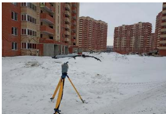
Рис. 2. Геодезическая съемка поверхности фасадов с определением отклонения плоскости облицовки
