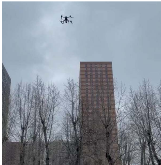
Рис. 1. Фотосъемка с квадрокоптера с последующей фотограмметрической обработкой полученной модели
